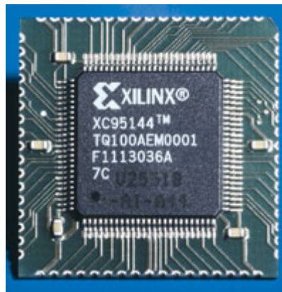
Bild 5. Das auf dem Leiterplattenträger montierte CPLD mit den fünf Stützkondensatoren passt elektrisch und mechanisch an die Stelle des Original-ASICs im PLCC68-Gehäuse.
